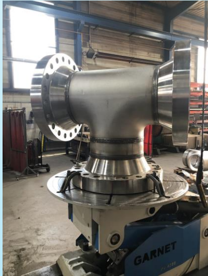
Soudure inox pièce gazoduc
